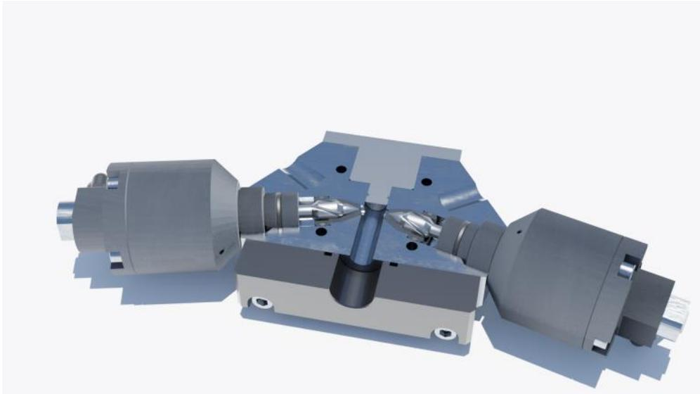
Das Design der beiden Düsen erzeugt einen Rotations-Effekt auf die Komponenten; jeder Rotations-Effekt verläuft entgegengesetzt, um die Mischeffizienz zu erhöhen.
